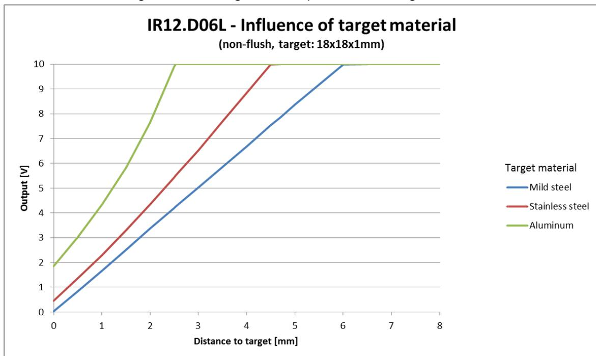
Diagramme des détecteurs IR12-D06L : caractéristiques de sortie (valeurs typiques) pour des objets mesurés de matériaux différents avec montage non noyé.
