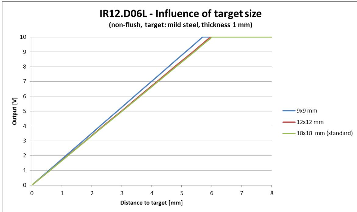
Diagramme des détecteurs IR12-D06L : caractéristiques de sortie (valeurs typiques) pour des objets mesurés de différentes grandeurs avec montage non noyé. Un objet mesuré de 9 x 9 mm génère une caractéristique de sortie plus accentuée d'environ 8 %, un objet mesuré de 12 x 12 mm une courbe plus accentuée de seulement 2 % env. que la plaquette de mesure normalisée (18 x 18 mm).
