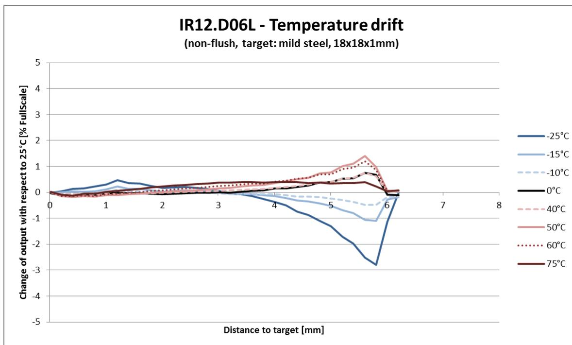
Diagramme des détecteurs IR12-D06L : dépendance à la température du signal de sortie (valeurs typiques) à des températures et des distances de mesure différentes en comparaison avec la température de référence (25 °C). Ces détecteurs présentent une très faible dépendance à la température, en particulier à des distances de mesure plus petites (0 ... 4 mm) et entre 0 et 40 °C.
