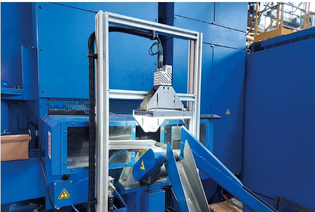
图 1：人工智能在质量控制中的应用：在流水线末端，堡盟 AX 智能相机正在检查垫圈是否存在裂纹。 图片来源：SBE-VARVIT
