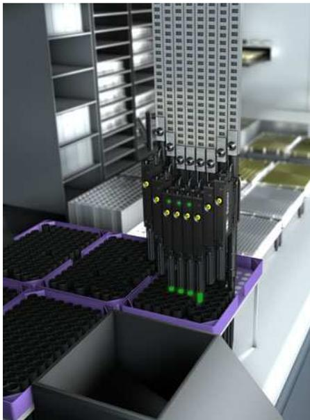
*Bild 2: Detektion von kleinen Pipettierspitzen im Labor mit Ultraschall-Sensoren*
