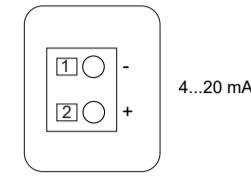
Das Gerät wird über die 4...20 mA Stromschleife versorgt.
