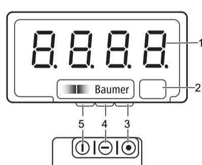
Après la mise sous tension, l'appareil se trouve en mode **RUN**. Il fournit la valeur actuelle (valeur réelle). Mode **PROG** sert pour la configuration entière de l'appareil.
