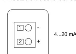
L'alimentation de l'appareil se fait par la boucle de tension 4...20 VDC.
