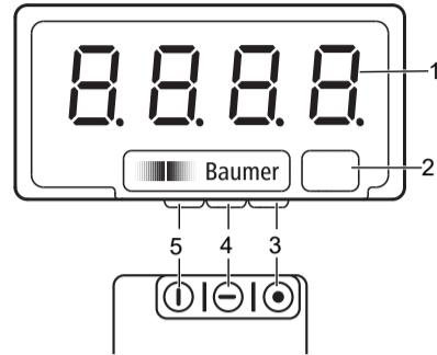
Das Gerät befindet sich nach dem Einschalten der Betriebsspannung im Modus **RUN**. Es wird der aktuelle Wert (Istwert) angezeigt.
