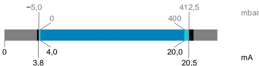
**Abb. 3: Stromsignalisierungsbereich am Beispiel eines 400 mbar-Drucksensors**
